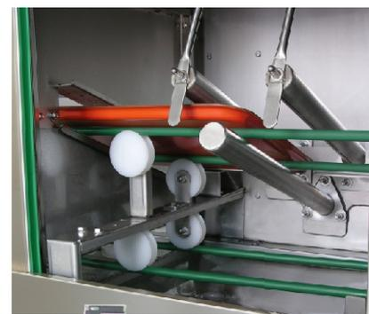
Sistema de secado a triple lama de aire.
