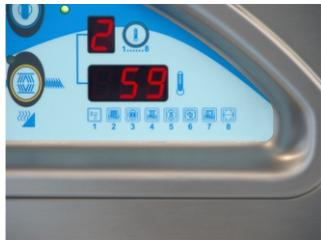
El termómetro visualiza a través de una luz intermitente el valor de cada una de las temperaturas de alimentación, lavado y aclarado.
